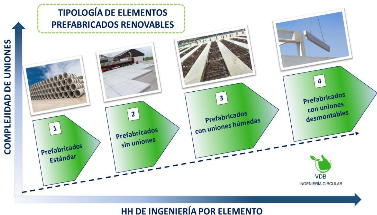
Imagen 10: Tipos 1 a 4 de Elementos Prefabricados en hormigón
